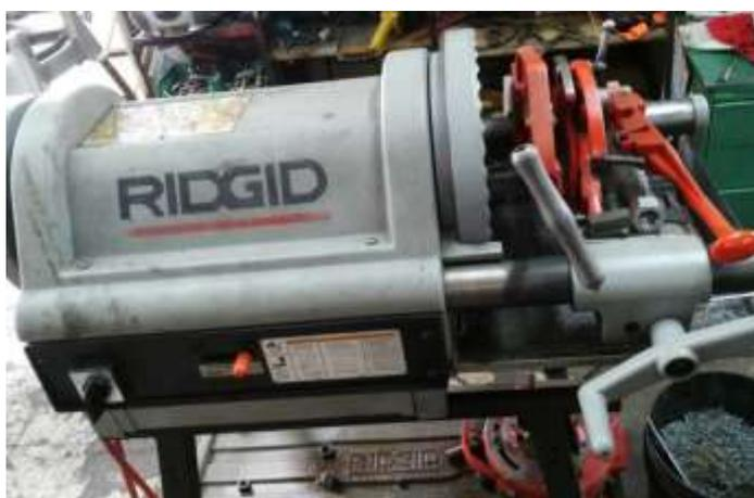
**Figura # 7** Máquinas roscadoras "RIDGID".
