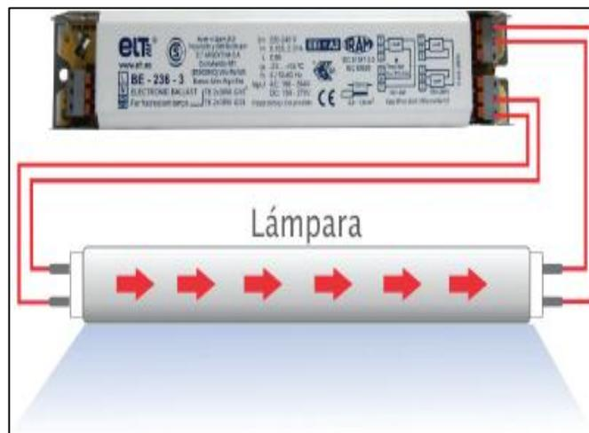
Figura 2. 11 Balasto de una Lámpara
