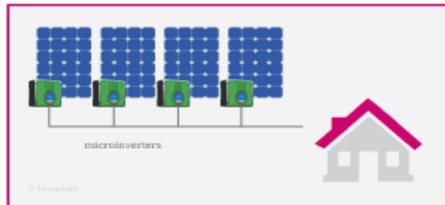
Figura 13 Ilustración de configuración de micro inversores.
