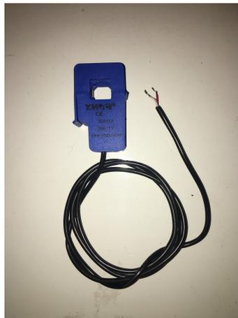
Figura 27 Sensor de Corriente
