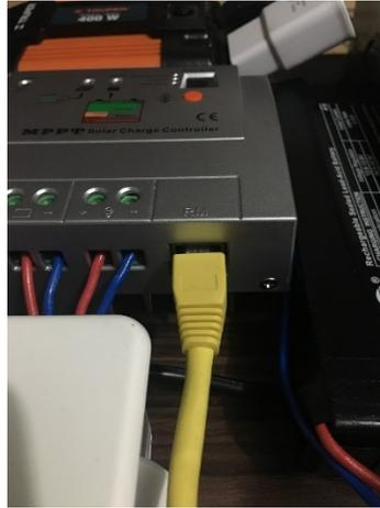
Figura 33 Conexión física del conector RJ45 al controlador de carga
