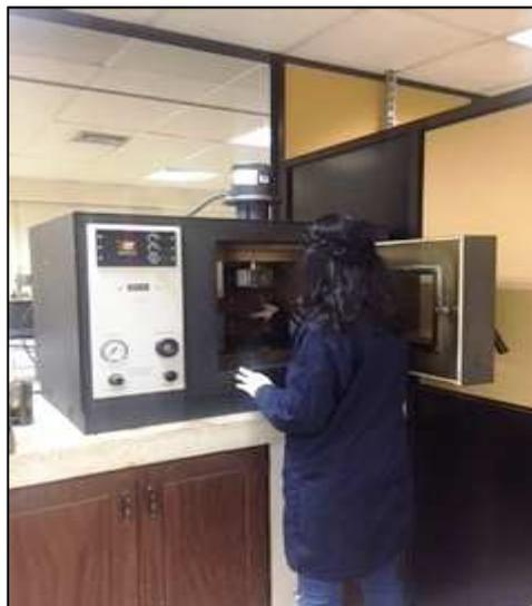
**Figura 11. Ensayo de Envejecimiento en horno de película delgada**
