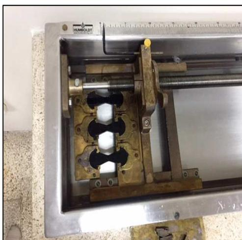
**Figura 12. Ensayo de Ductilidad**
