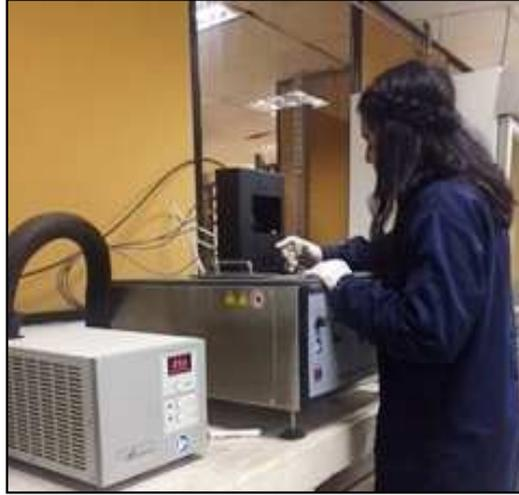
**Figura 15. Reómetro de viga a flexión**
