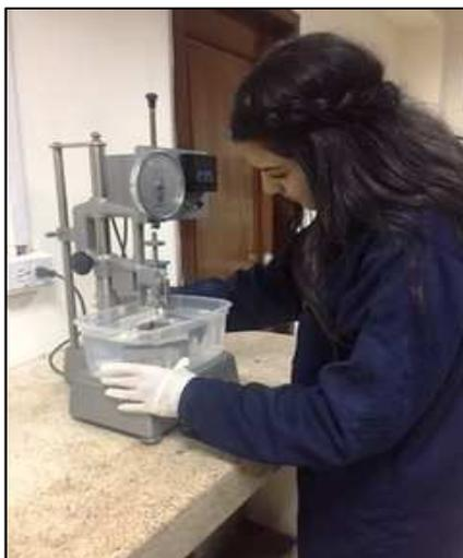
**Figura 7. Ensayo de Penetración**
