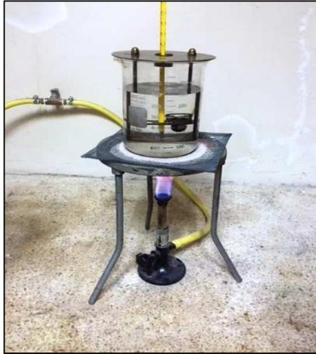
**Figura 8. Ensayo de Punto de Ablandamiento**
