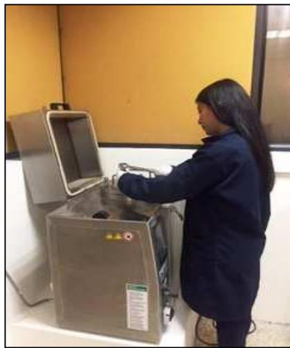
**Figura 13. Cámara de envejecimiento a presión**
