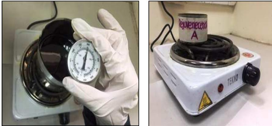
**Figura 3. Control de la temperatura del asfalto base y del rejuvenecedor**
