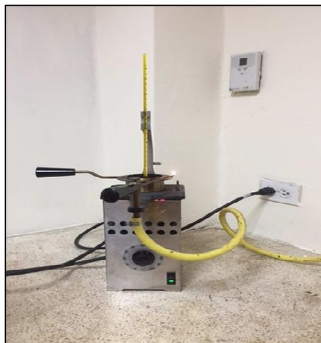
**Figura 10. Ensayo de Punto de Inflamación**
