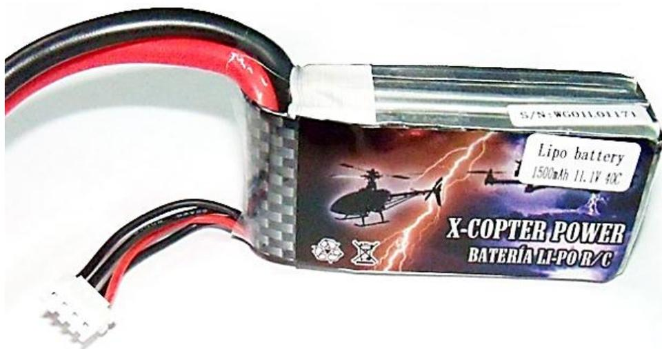
Figura 3. 10: Batería de Lipo tres celdas
