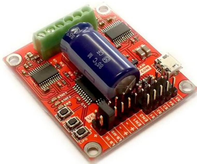
Figura 3. 9: Tarjeta controladora RoboClaw 2x5
