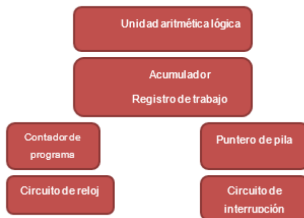
Figura 2. 1: Diagrama de bloques general de un microprocesador
