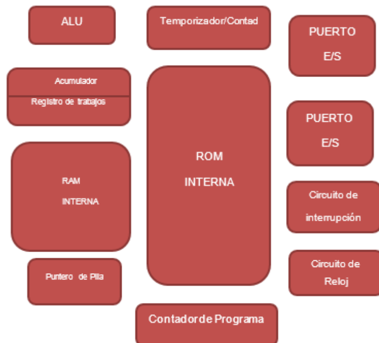
Figura 2. 2: Diagrama de bloques de un microcontrolador.
