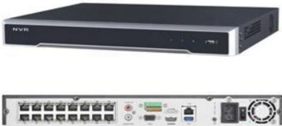
Figura 3.14: NVR de la marca Hikvision modelo DS-7600NI-I2 / 16P Fuente: (Hikvision, 2018)
