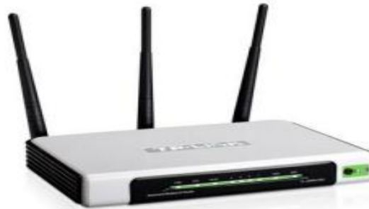
Figura 2.7: Router WI-FI con tres antenas Fuente: (Huidobro, 2013)
