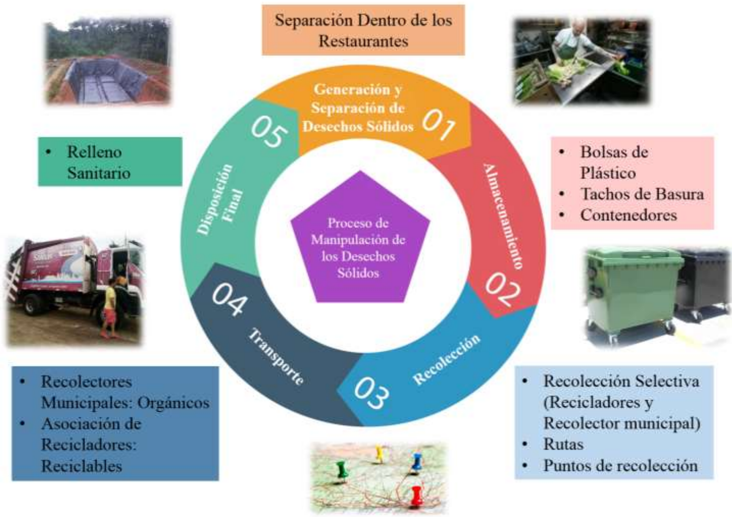
Figura 26. Diagrama de Ciclo Propuesto para el Proceso de Manipulación de los Desechos Sólidos.
