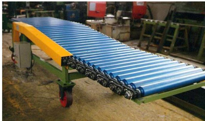
Figura 17. Cinta transportadora de rodillo
