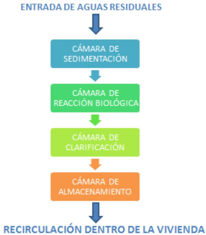
Figura 49: Diagrama de flujo de prototipo
