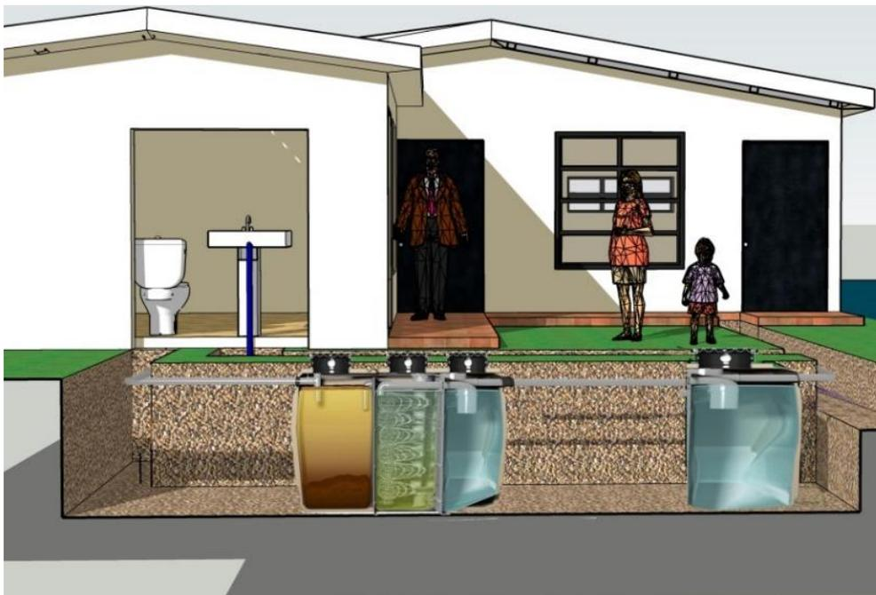
Figura 48: Funcionamiento de prototipo de recirculación y depuración de agua
