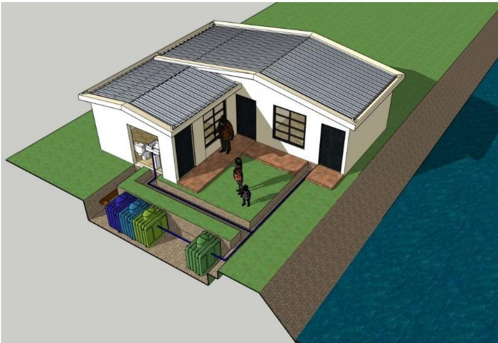
Figura 47: Propuesta de prototipo de recirculación y depuración de agua
