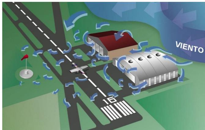
Figura 3: Turbulencia causada por construcciones hechas por el hombre
