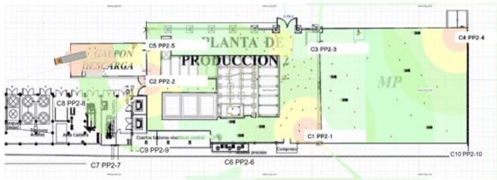
Figura 3. 18: Esquema de instalación del sistema de videovigilancia en la planta de producción B.
