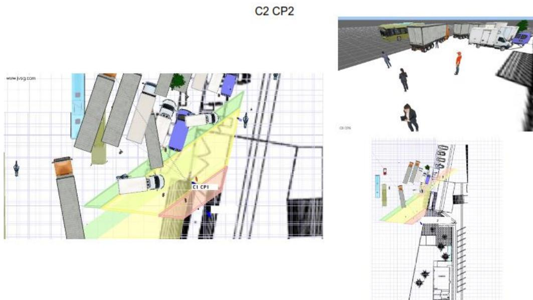
Figura 3. 36: Esquema de instalación del sistema de videovigilancia en cerco perimetral C2 CP-2.
