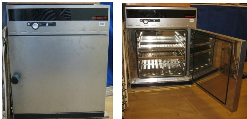
Imagen 3 Horno tipo SNB con capacidad de 220°C
