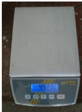
Imagen 2 Balanza de precisión de 0.01gr
