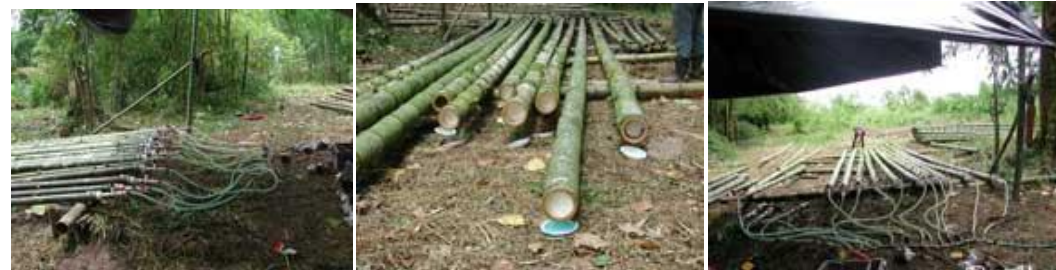
Preservación de Guadua angustifolia mediante el método de Boucheri modificado. Estación Experimental Los Diamantes, Guápiles, Costa Rica.
