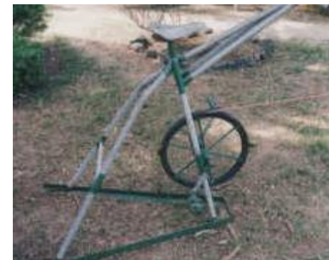
Modelo de bicibomba, con una bicicleta construida a partir de tubos galvanizados.
