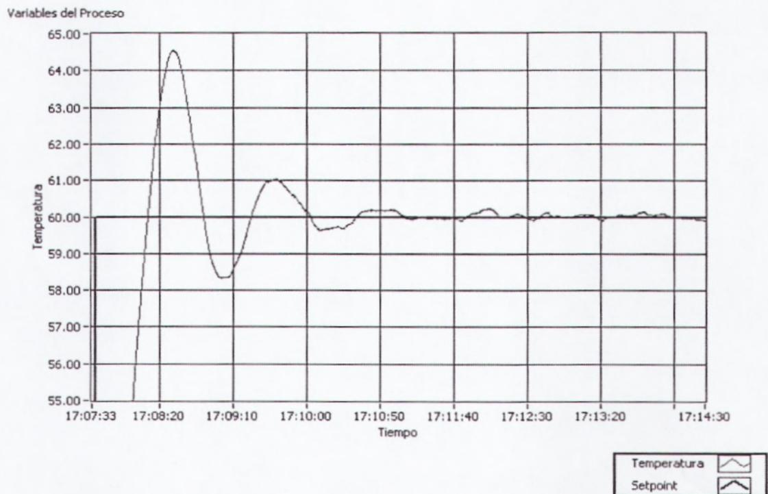
Figura 4.15: Respuesta a Cambios Parámetros PID
