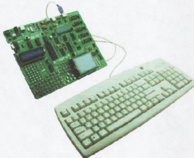
Figura 3.21: EasyPic6 conectado al teclado. Fuente [Mikroelektronika]
