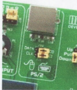
Figura 3.20: Conector PS/2 (J20 y J21 puentes no colocados). Fuente [Mikroelektronika]
