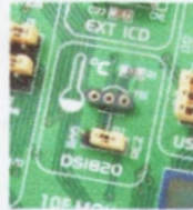
Figura 3.30: Puente J11 en la posición RA2 (comunicación 1-wire realizada por el pin RE2). Fuente [Mikroelektronika]
