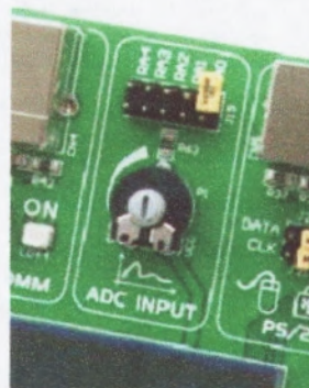
Figura 3.32: ADC (posición por defecto del puente). Fuente [Mikroelektronika]
