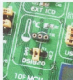
Figura 3.28: Conector DS1820 (no se utiliza la comunicación 1-wire). Fuente [Mikroelektronika]
