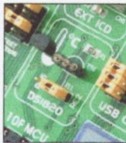
Figura 3.27: Sensor DS1820 colocado en el zócalo apropiado.
