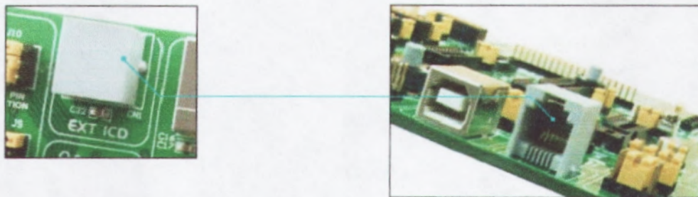
Figura 3.22: Conector ICD. Fuente [Mikroelektronika]
