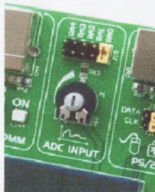
Figura 3.33: Pin RA0 utilizado como una entrada para la conversión A/D.
