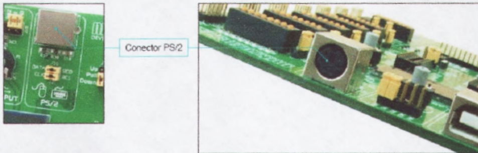
Figura 3.19: Conector PS/2 (J20 y J21 puentes colocados). Fuente [Mikroelektronika]
