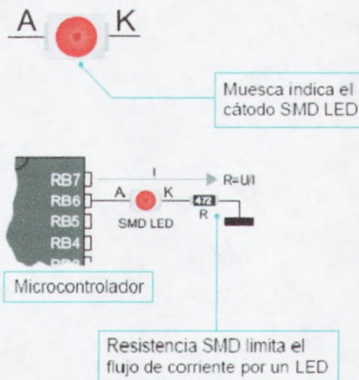
Figura 3.38: Indicador del cátodo y flujo de corriente por un LED. Fuente [Mikroelektronika]
