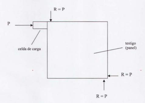
Para la prueba de corte, se coloca la pared de forma recta y se colocan apoyos en la parte inferior, ya que este elemento tiende a desplazarse y girar en la esquina diagonal opuesta, debemos asegurarla con topes o elementos rígidos apoyados sobre placas, esto se colocan entre la mampostería y el pórtico. Una vez asegurada se coloca el gato hidráulico en una de sus caras. Luego se va aplicando cargas constantes de 100 PSI y se toman los datos hasta que el elemento falle.
