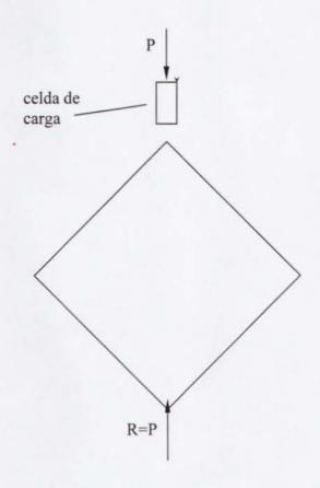
El esquema del esfuerzo de compresión consiste en ir abatiendo las paredes hasta obtener una forma romboidal, para luego irlas montando en unas bases rectangulares una en el extremo superior y la otra en el extremo inferior, en donde van a ser aplicadas la carga de manera axial en la parte superior de la pared ejercida por el gato, provocando de esta manera una reacción de igual magnitud opuesta en el extremo inferior hasta que el elemento falle.
