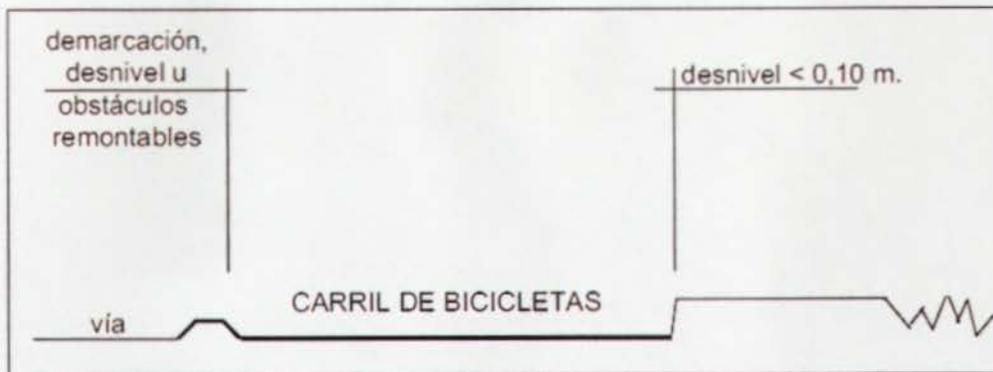
**Figura# 23** Sección transversal de una faja de bicicletas
