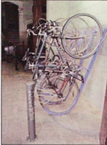
Aparcamiento con soportes de pared inclinados (Fundació Terra/MODULAR)
