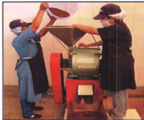
Imagen 5. Proceso de primera molienda
