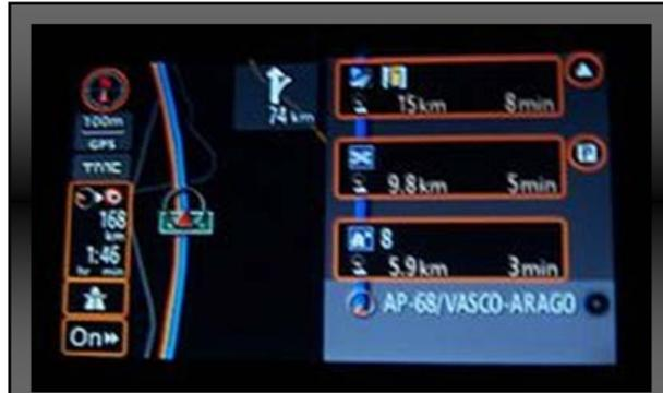
Fig. 2.10 Navegador GPS de pantalla táctil de un vehículo con información sobre la ruta, así como las distancias y tiempos de llegada al punto de destino
