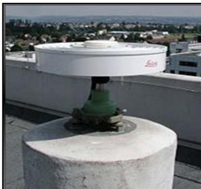
Fig. 2.8 Estación de referencia DGPS
