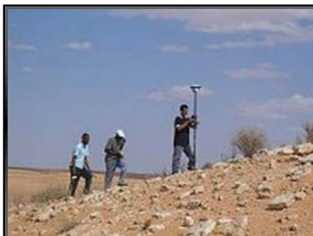
**Fig. 2.7 Receptor GPS Navcom SF-2040G StarFire montado sobre un mástil**
