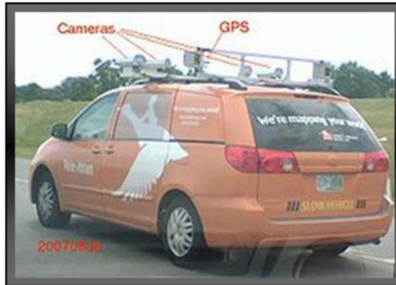
**Fig. 2.9 Vehículo de la empresa Tele Atlas con GPS cartografiando y fotografiando las carreteras en Rochester, Nueva York (EE.UU.)**
