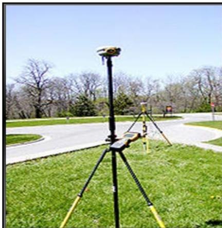
**Fig. 2.4 Estación y receptor GPS profesionales para precisiones centimétricas**
