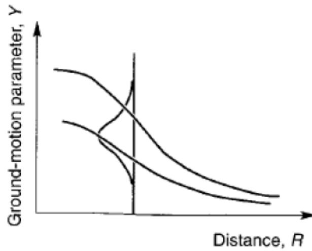
Figura 2 Ecuación de predicción de intensidad sísmica
