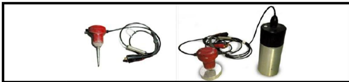
**FIGURA 4 Geófonos que pueden ser fijados al suelo (izquierda), o que pueden ser apoyados sobre el suelo o alguna superficie rígida (derecha) (Guarachi et al., s. f.)**
