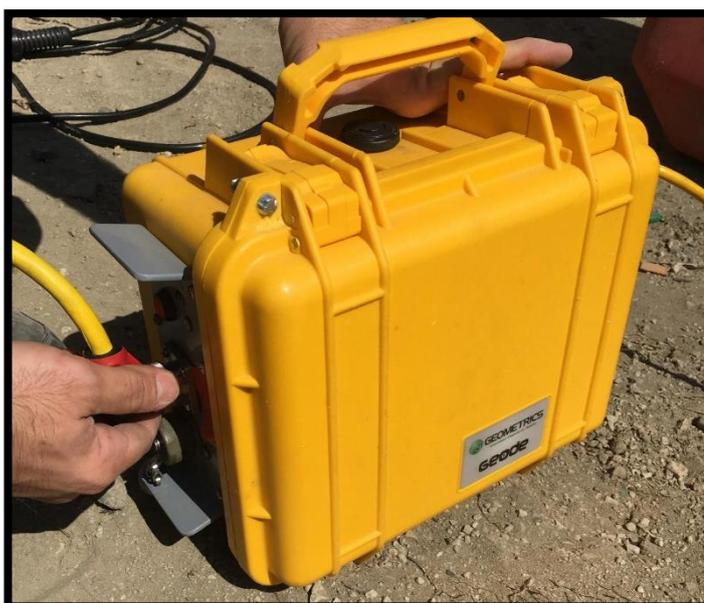
**FIGURA 3 Sismógrafo GEODE de la empresa GEOMETRIC**
