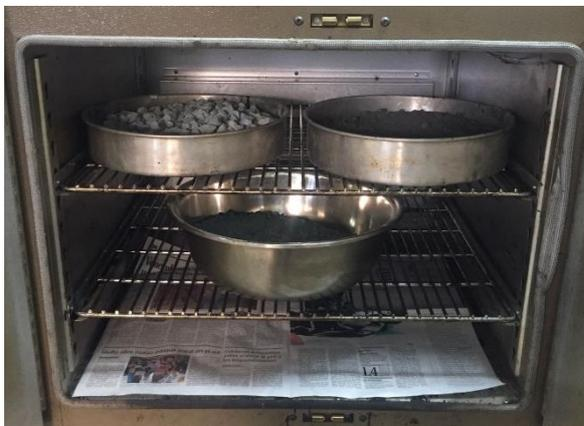
**Figura 3. 1 Agregados en el horno**
