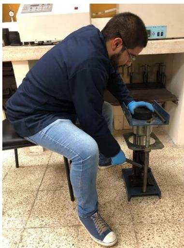
**Figura 3. 8 Desmolde de briqueta**
