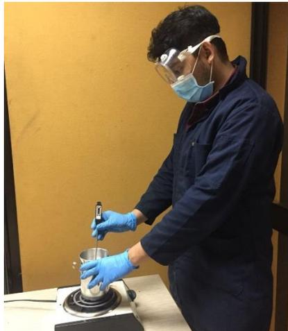
**Figura 3. 3 Toma de temperatura a cemento asfáltico**
