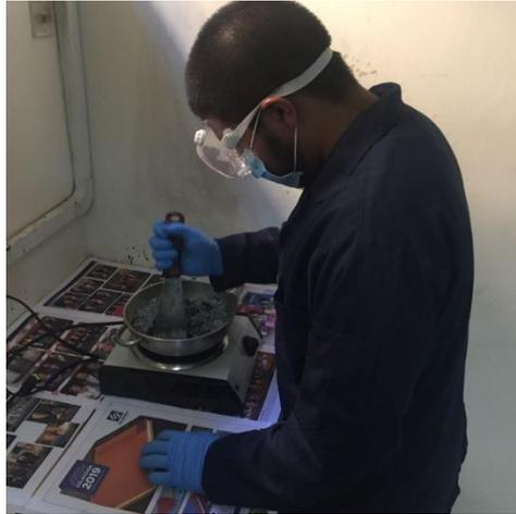
**Figura 3. 4 Mezcla de agregados con asfalto**
