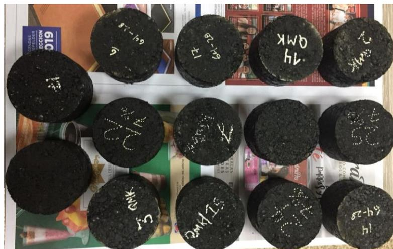
**Figura 3. 9 Muestra de briquetas elaboradas**
