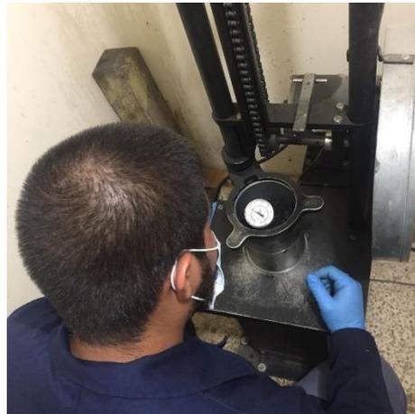
**Figura 3. 7 Toma de temperatura de compactación**
