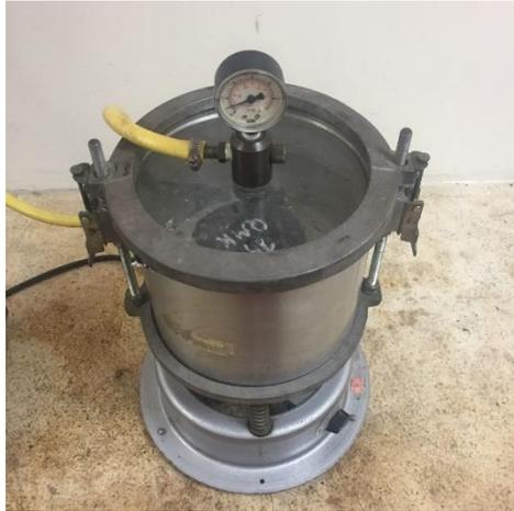
**Figura 3. 11 Saturación de briqueta**
