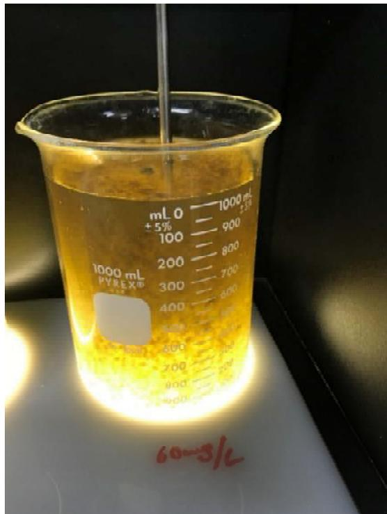
Fotografía 25. Jarra #6. Dosis de 60 mg/l de  $\text{FeCl}_3$  con 1 ml de Polímero Aniónico
