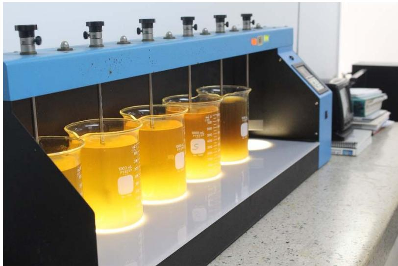
Ilustración 17 Máquina para la realización de la prueba de jarras.
