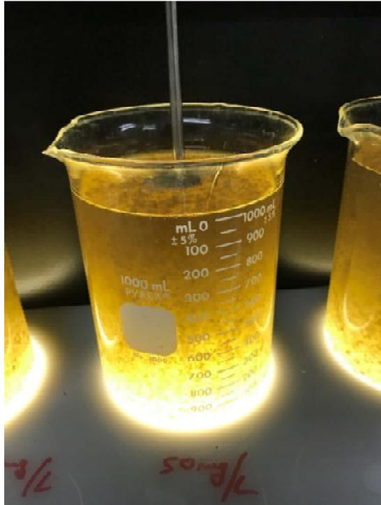
Fotografía 26. Jarra #5. Dosis de 50 mg/l de  $\text{FeCl}_3$  con 1 ml de Polímero Aniónico
