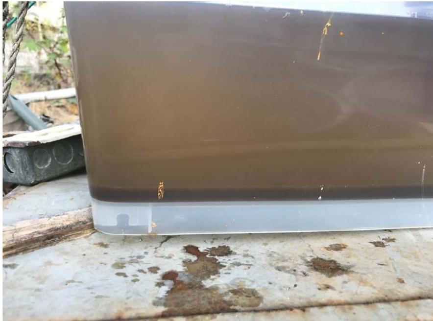
**Fotografía 39. Tanque de Mezcla Rápida con 50 mg/l de Cloruro Férrico con 1 ml de Polímero Aniónico.**
