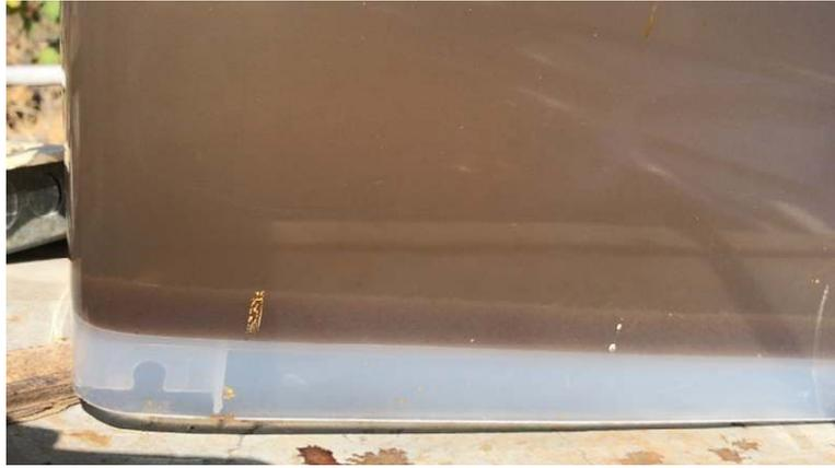
**Fotografía 40. Funcionamiento del Tanque de Mezcla rápida con 30 mg/l de Cloruro Férrico adicional con 1 ml de Polímero Aniónico.**
