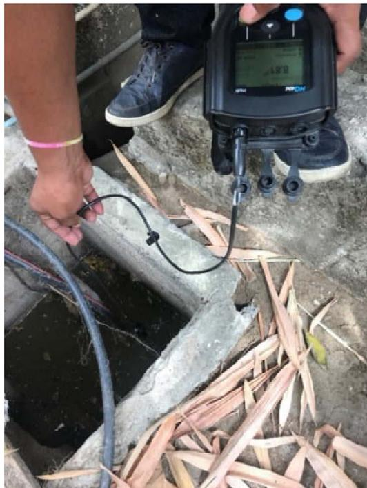
**Fotografía 6. Medición de pH agua residual domestica día 2-Planta Piloto**
