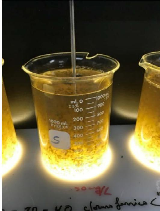
Fotografía 24. Jarra #3. Dosis de 30 mg/l de  $\text{FeCl}_3$  con 1 ml de Polímero Aniónico
