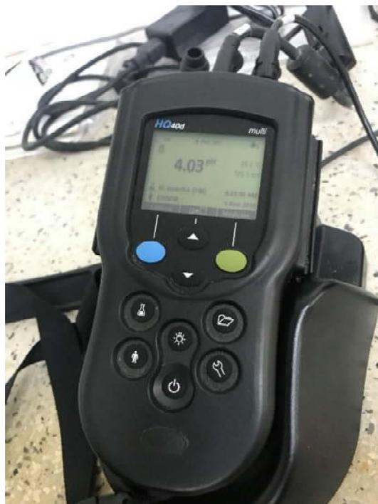
Fotografía 2. HQ40D Portable Multi Meter marca "HATCH"
