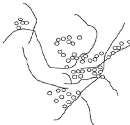
**Ilustración 15 El floculante tiende un puente entre las partículas coloidales aglomeradas.**
