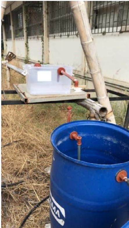
**Fotografía 31. Tanque Mezcla Rápida, Tanque de Coagulación**
