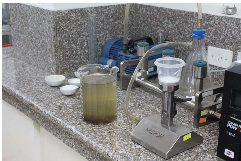
**Ilustración 21** Preparación de las muestras para análisis de SST.
