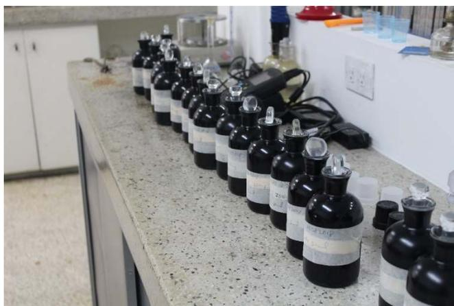
**Ilustración 19 Preparación de las muestras de DBO.**
