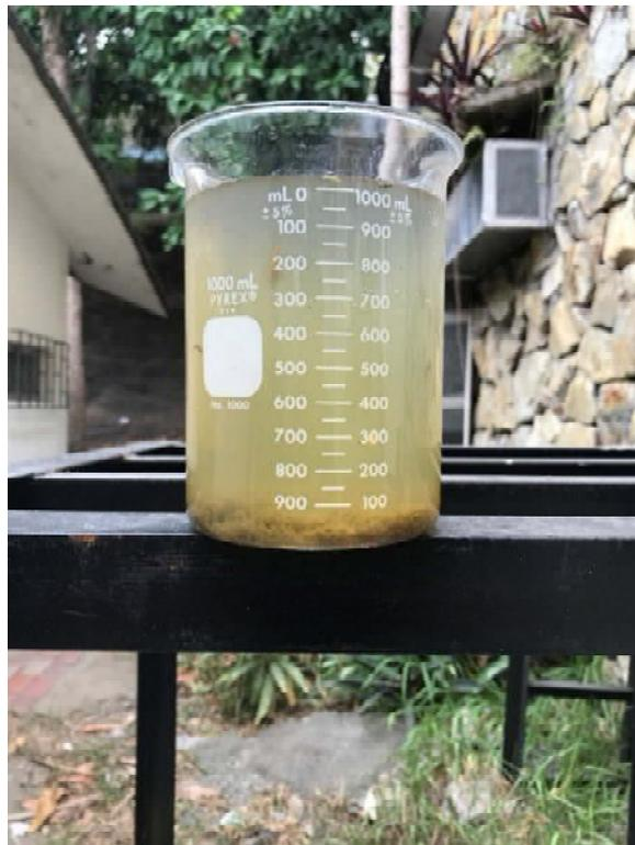
**Fotografía 27.** Jarra #6 con mayor grado de eficiencia en la formación de flocs y tiempo de sedimentación.
