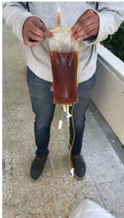
**Fotografía 33. Ajuste de las dosificaciones de Cloruro Férrico**
