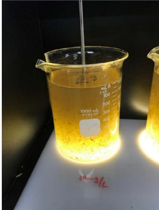
Fotografía 22. Jarra #1. Dosis de 10 mg/l de  $\text{FeCl}_3$  con 1 ml de Polímero Aniónico
