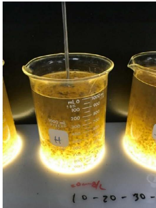
Fotografía 21. Jarra #2. Dosis de 20 mg/l de  $\text{FeCl}_3$  con 1 ml de Polímero Aniónico
