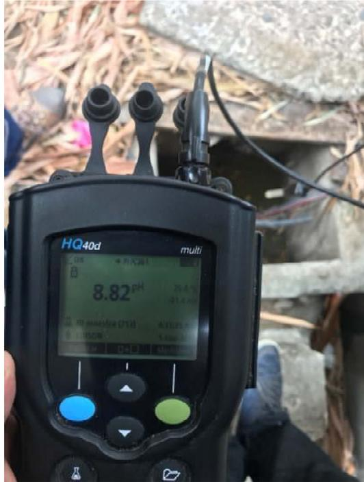
**Fotografía 5. Medición de pH agua residual domestica**
