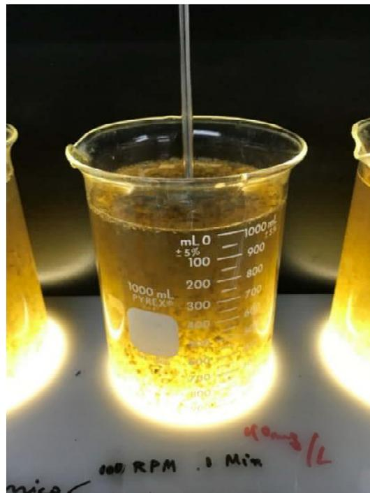
Fotografía 23. Jarra #4. Dosis de 40 mg/l de  $\text{FeCl}_3$  con 1 ml de Polímero Aniónico
