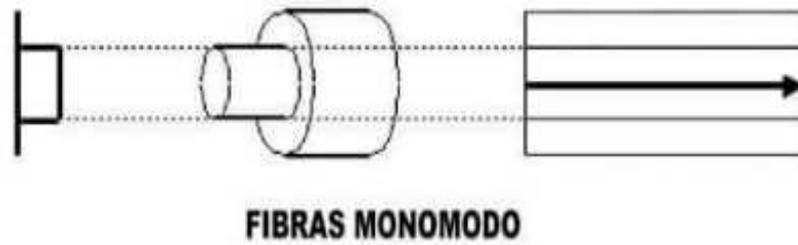
Figura 2. 10: Fibra óptica monomodo
