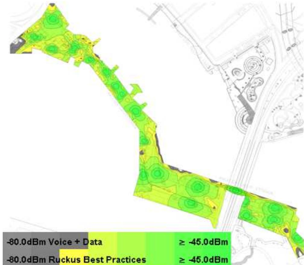
Figura 3. 24: Intensidad de señal para Wifi Malecón del Salado en banda de 5 GHz
