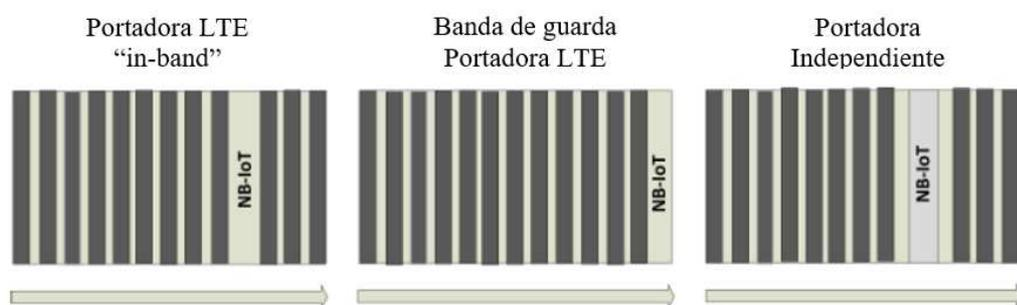
Figura 4.4: Modelos de despliegue NB-IoT.
