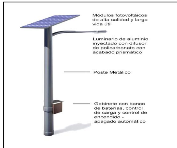
Figura 4. 4 Partes de una luminaria solar LED. Fuente: (Colpilas, 2015)
