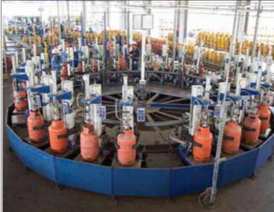
*Figura 2. 15 Proceso de producción de gas licuado de petróleo en Monteverde - El chorrillo
