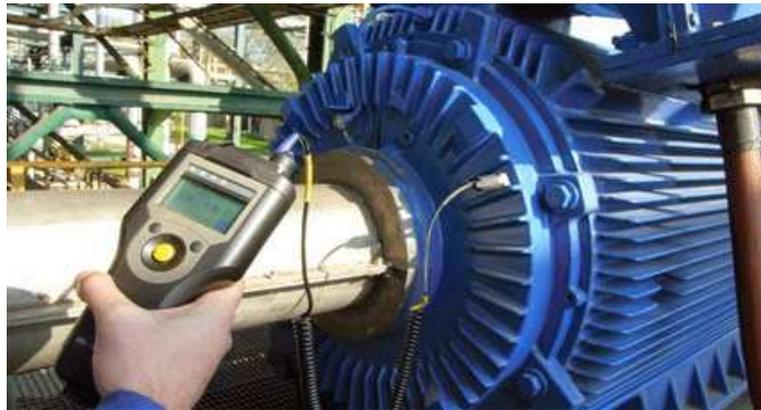
Figura 2. 10 Monitoreo de Excentricidad en motor eléctrico
