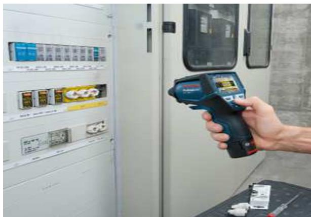
Figura 2. 28 Cámara de temperatura
