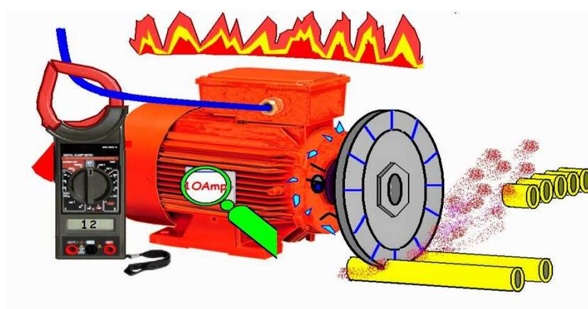
Figura 2. 2 Ejemplo de Sobrecorriente en un motor eléctrico
