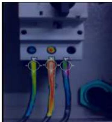
Figura 2. 14 Monitoreo de sistemas eléctricos
