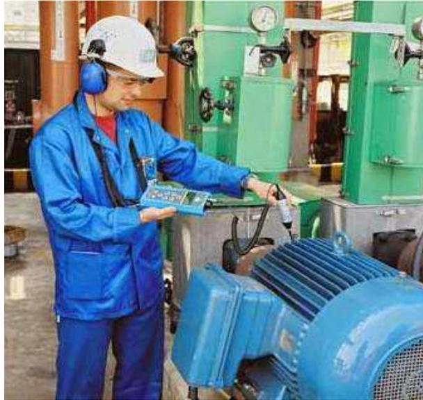
Figura 2. 11 Monitoreo de vibraciones por rodamientos
