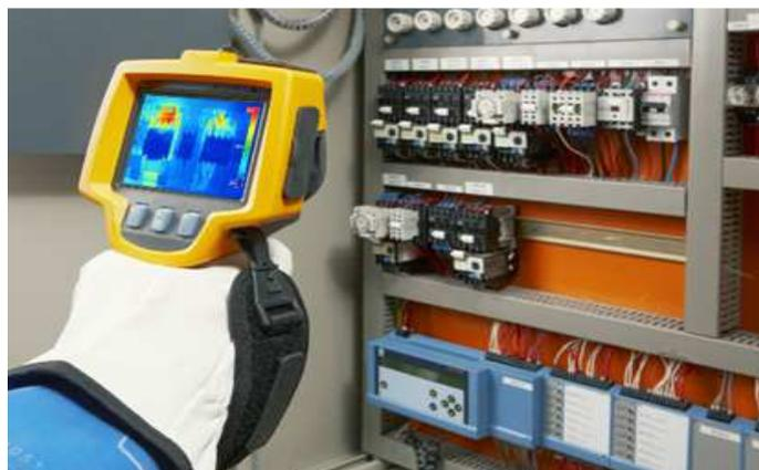
Figura 2. 30 Monitoreo térmico en instalaciones eléctricas
