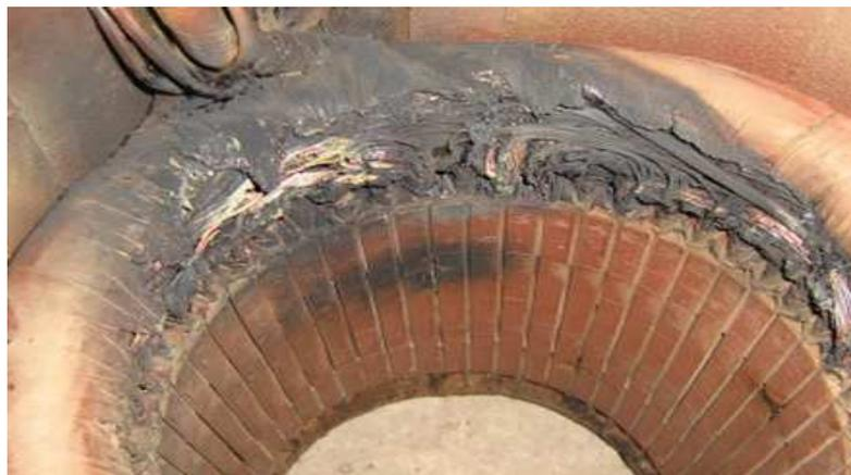
Figura 2. 5 Ejemplo de bobinado quemado
