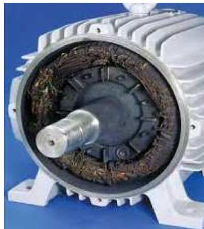
Figura 2. 7 Bobinado totalmente quemado por calentamiento excesivo
