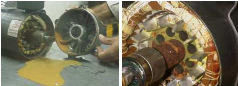
Figura 2. 9 Caso de motor por humedad
