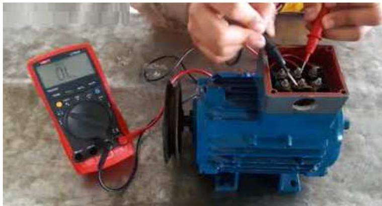
Figura 2. 6 Prueba de resistencia/aislamiento en motor eléctrico
