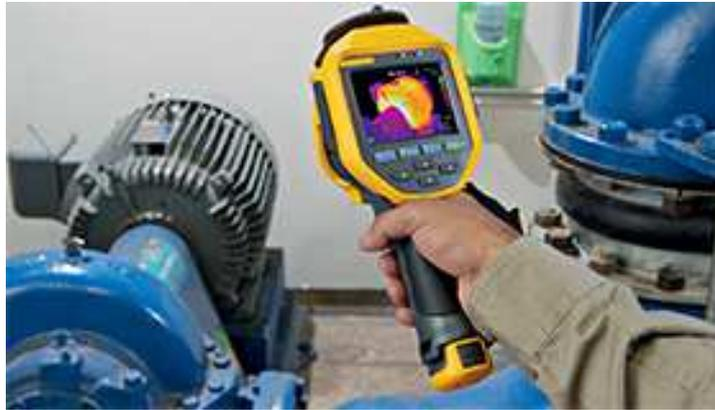
Figura 2. 15 Cámara termográfica portátil
