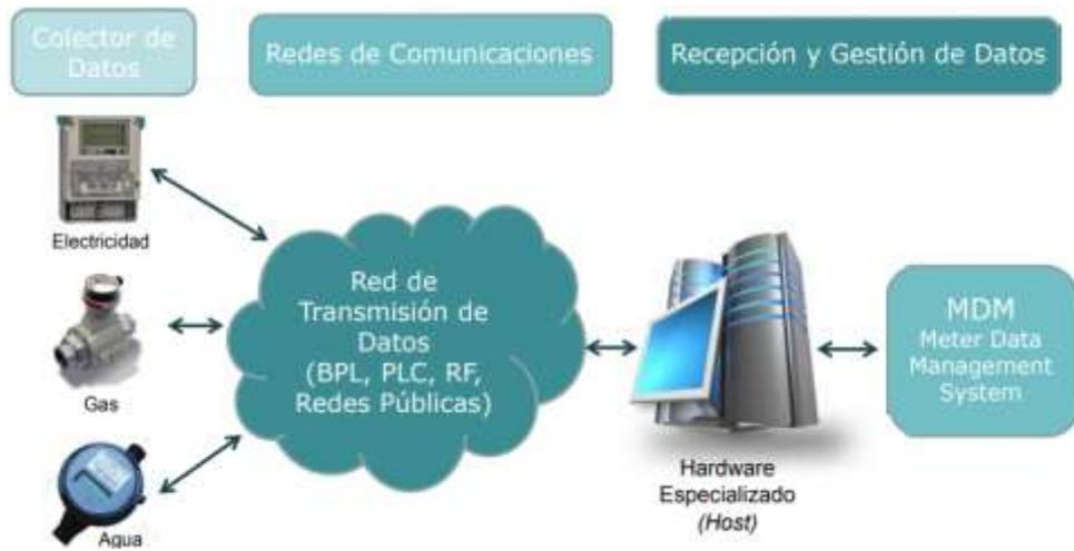
Figura 3. 6 Sistema de Medición avanzada
