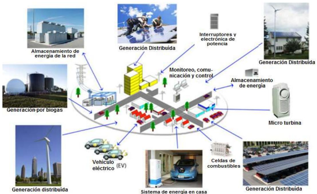
Figura 2. 12 Infraestructura M2B de red eléctrica inteligente 'Smart Grid'
