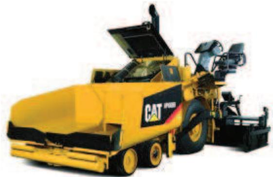
Ilustración 10: Pavimentadora CAT.
