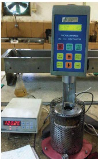
**Ilustración 1: Viscosímetro digital Brookfield.**
