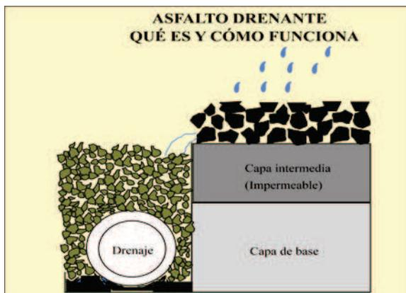
Ilustración 2: Estructura y funcionamiento de los asfaltos drenantes.
