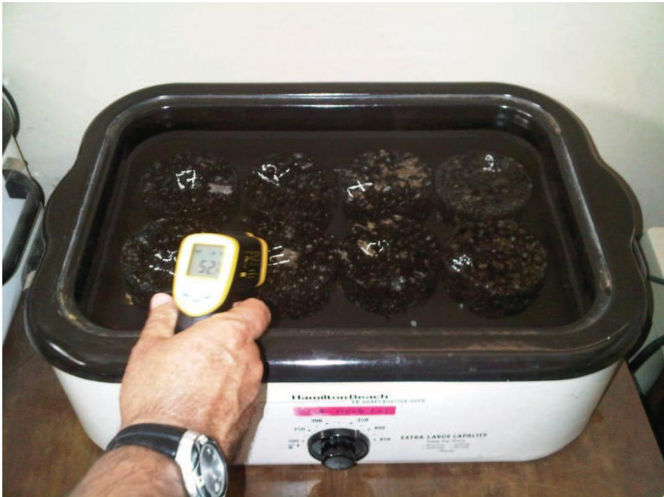
**Ilustración 9:** Vemos en la grafica, las muestras sumergidas en agua a 60 grados centígrados por 24 horas.
