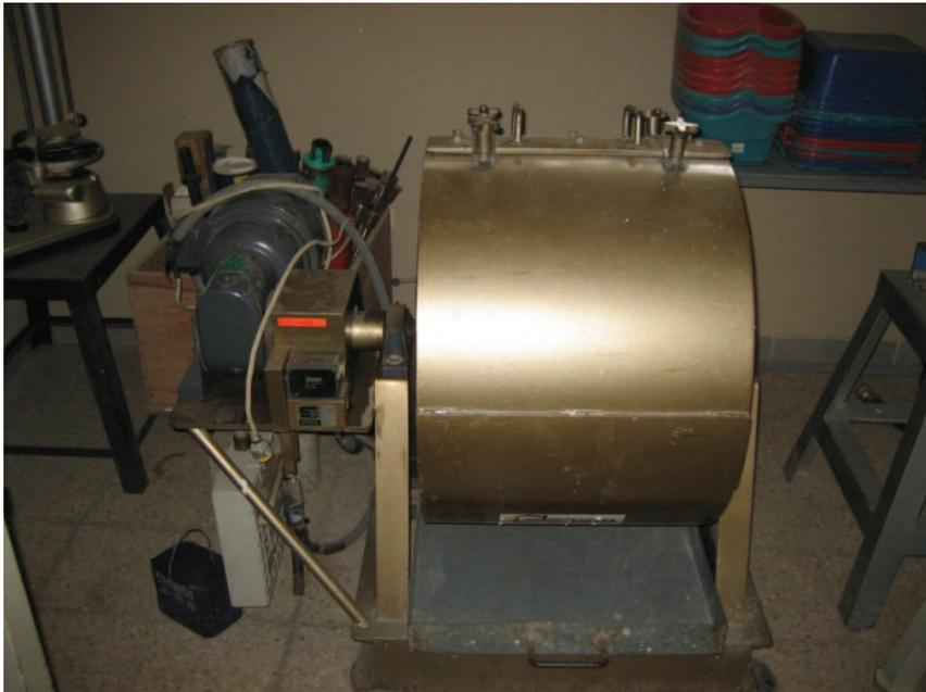
Una vez colocadas las pastillas en el tambor, calibrado entre 30 a 33 rpm, se introduce una pastilla en el tambor para pasar por 300 vueltas dentro del mismo, una vez terminando, la porción de pastilla la extraemos y la pesamos, con dichos valor y según las norma NLT-352/00 procedemos con el cálculo.
