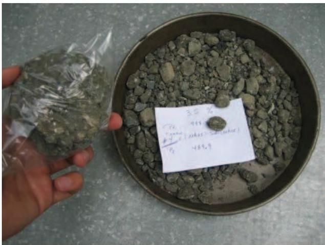
**Ilustración 8.:** Muestra resultante del ensayo de los Ángeles
