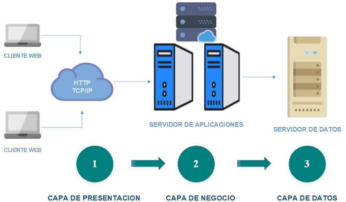
*Figura 6: Arquitectura de la Solución de Software de 3 Capas*
