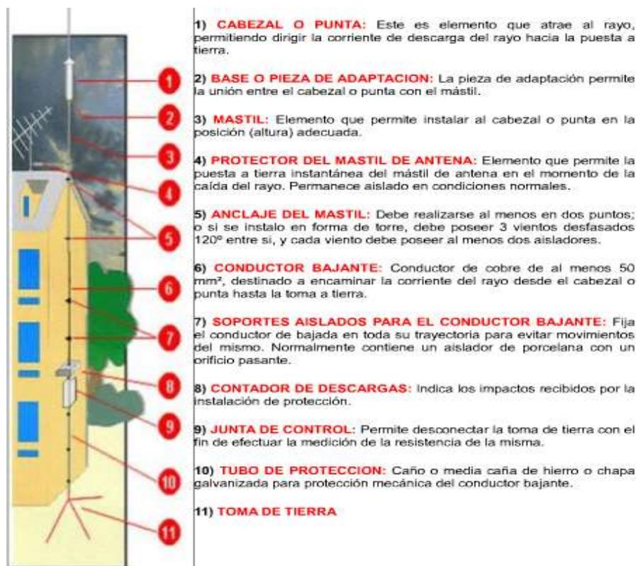
Figura2.3: Partes Principales de la instalación del Pararrayos implementado en la Facultad Técnica para el Desarrollo
