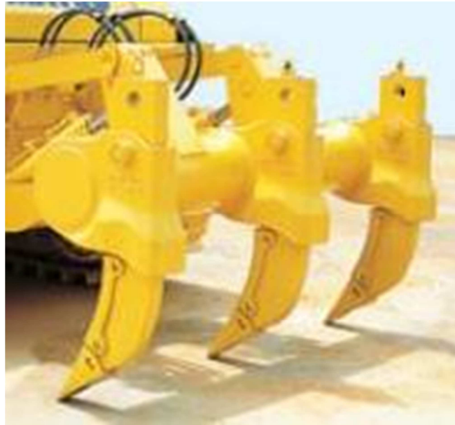
Foto #15: Escarificador de 3 dientes
