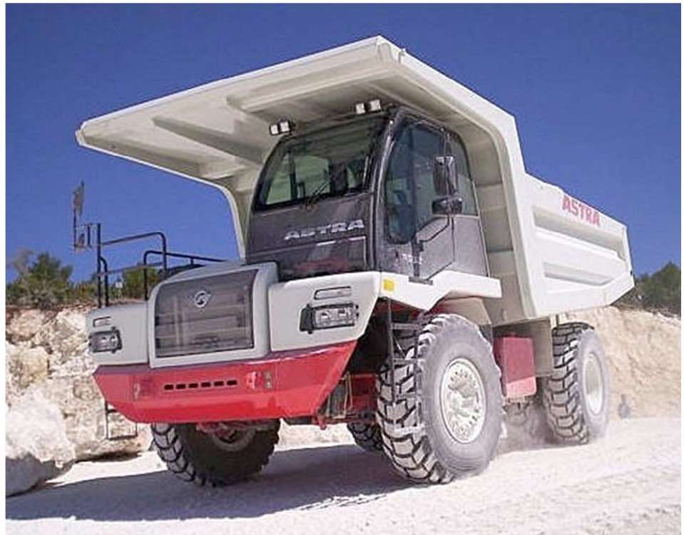
Foto #21: Dumper Rígido.
