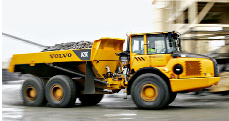
Foto #22: Dumper Articulado.
