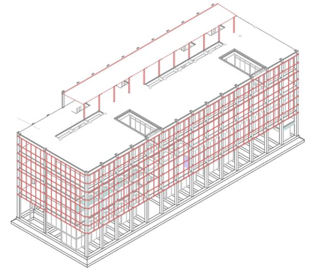
Cubierta superior para zona de instalaciones + Envoltura formada por una estructura prefabricada de acero que funciona como arriostramiento y soporta una red de acero inoxidable de malla larga
