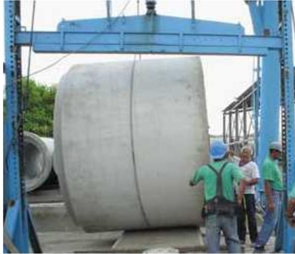
***Imagen 1. Pruebas de resistencia.***
