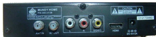
Figura 3.7: Decodificador de ISDB-Tb Mundy Home DEC-012B, panel posterior Fuente: Elaborado por el autor
