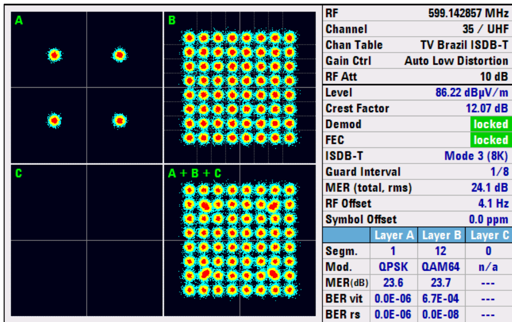
Figura 4.25: Diagrama de Constelación, intensidad de campo, MER y modulación de Canal 35 en la Ciudadela Atarazana.
