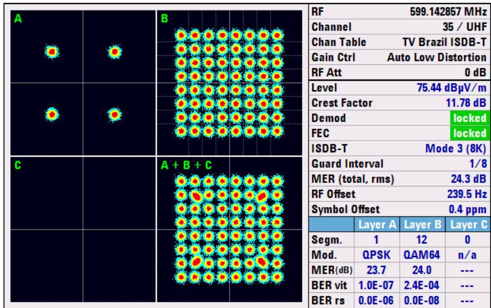
Figura 4.26: Diagrama de Constelación, intensidad de campo, MER y modulación de Canal 35 en la Ciudadela Itelel.
