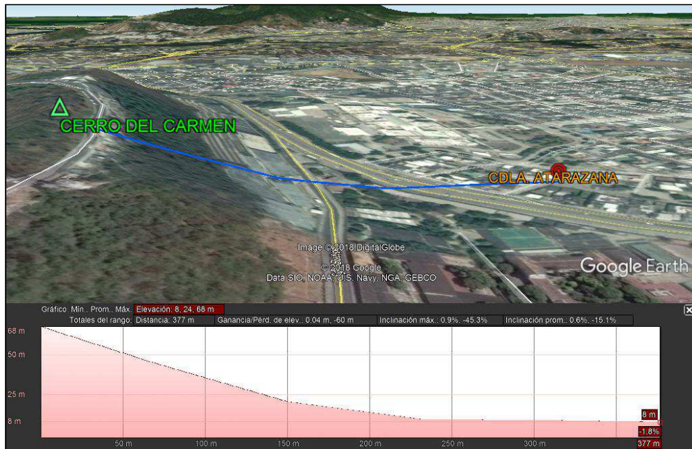
Figura 4.4: Perfil de elevación entre el Cerro del Carmen y la Ciudadela Atarazana. Fuente: Elaborado por el autor
