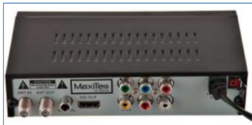
Figura 3.10: Decodificador de ISDB-Tb Maxitec diTV 168, panel posterior Fuente:(SUKASA, 2018)
