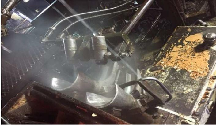
Figura 17. Sistema de lubricación de cucharas A2. Tomado de la Máquina A2, por Owens Illinois, 2019.
