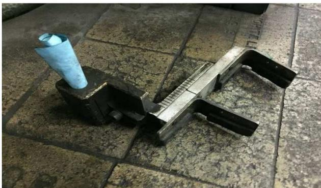
Figura 20. Barredores para envases cónicos. Tomado de la *Máquina A2*, por Owens Illinois, 2019.
