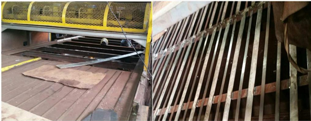
*Figura 13.* Cambio de malla del archa. Tomado de *trabajos realizados en marcha de la línea A1*, por Owens Illinois, 2019.
