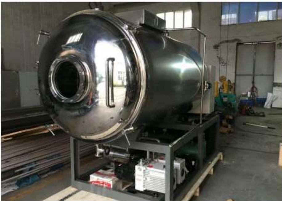
*Figura 6.* Maquina Liofilizadora.
