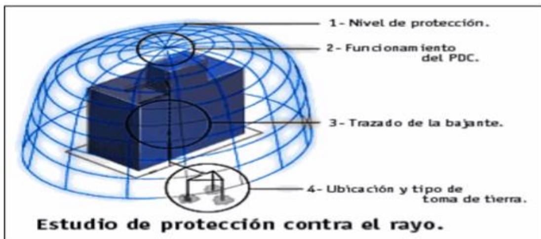
Figura 22 forma de apantallamiento contra descargas atmosféricas
