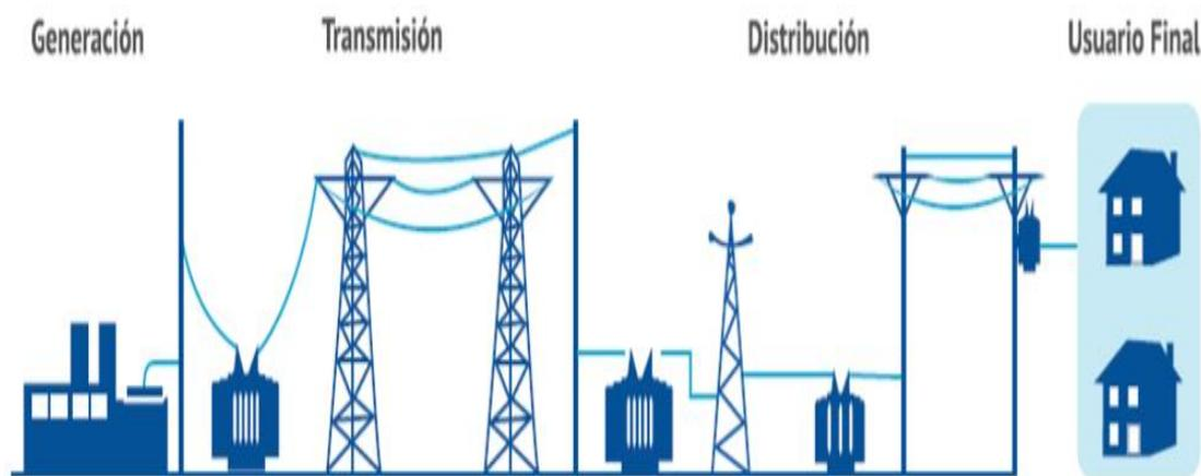
Figura 6 Estructura de un sistema de potencia típico.
