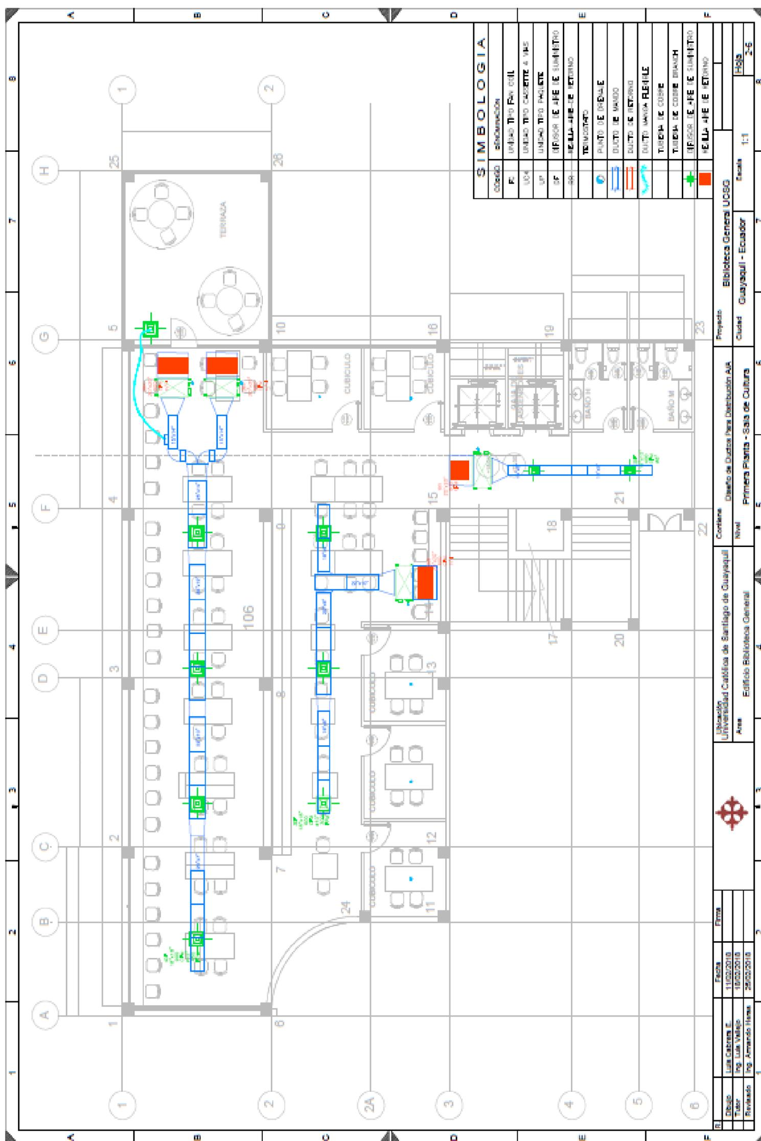
Figura 4 18 Diseño de ductos de aire acondicionado de 1er piso alto.
