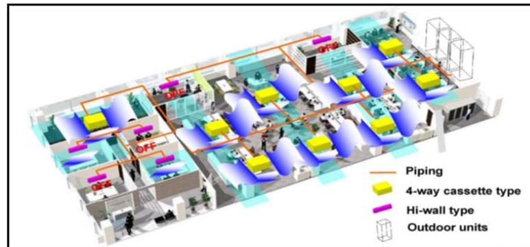
Figura 2. 9 Disposición de zonificación para el sistema VRF
