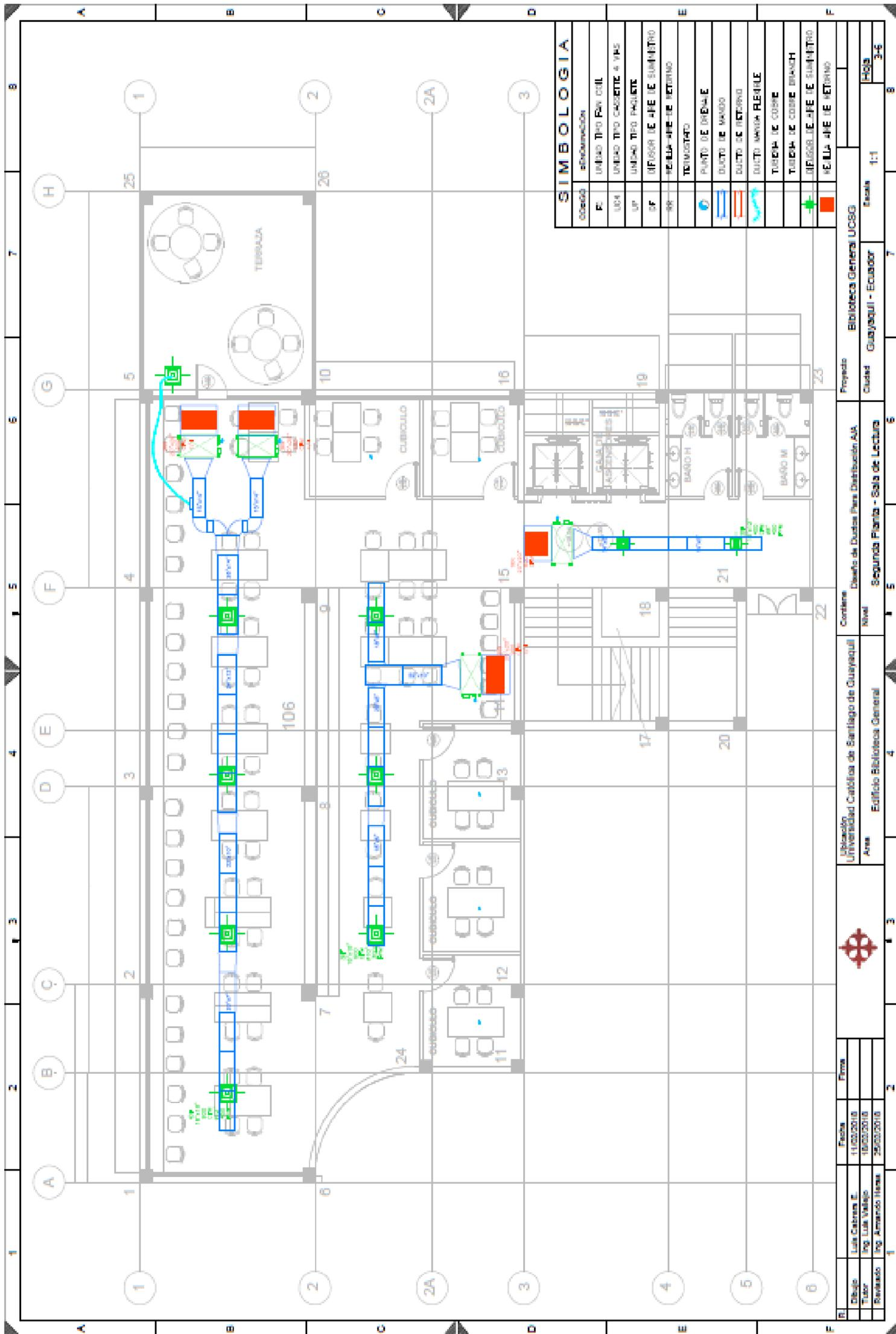
Figura 4 | 19 | Diseño de ductos de aire acondicionado del 2do piso alto.
