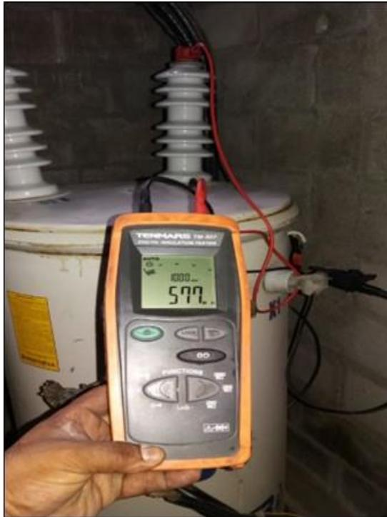
Figura 5.11 Prueba de aislamiento
