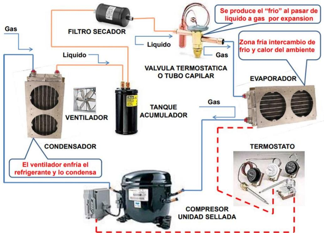
**Figura 2. 2. Sistema de refrigeración típico**
