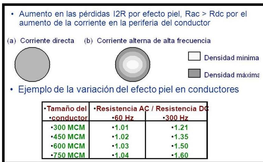
Figura 35: Desgaste de cables por armónicos / efecto piel
