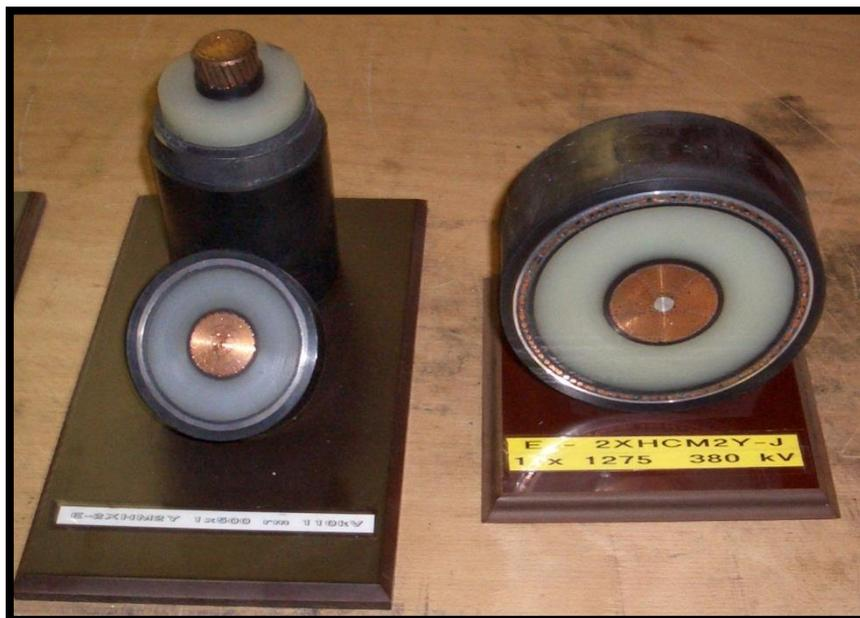
Figura 46: Cable con blindaje 2XHCM2Y-J/400kV
