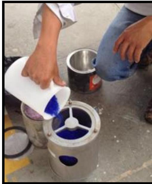
Figura 62: Llenado de silicagel nuevo hacia la cámara
