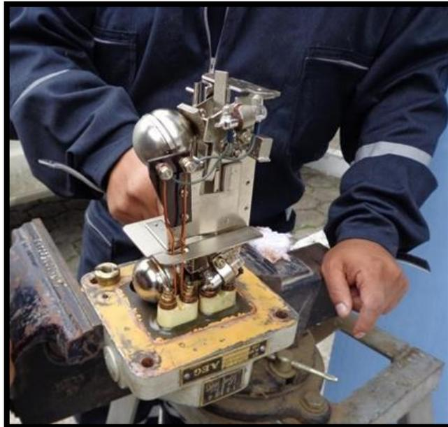
Figura 59: Relé Bulchholz desarmado para detectar fuga de aceite
