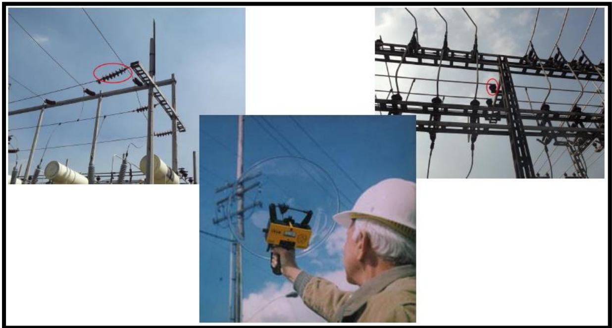
Figura 65: Aplicación del equipo ultrasónico
