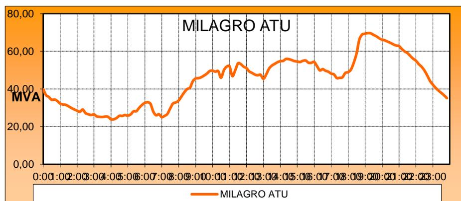
Figura 50: Curvas de flujo de transformadores
