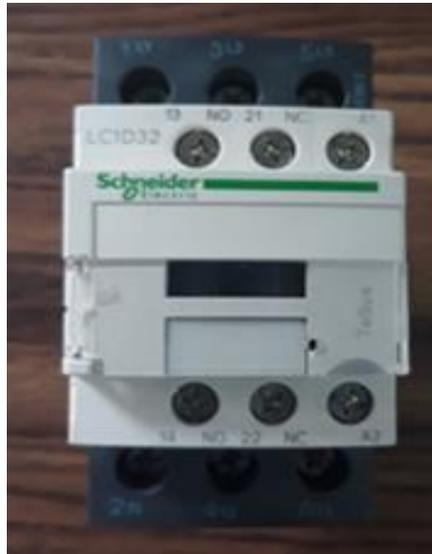
*Figura 6 Contactor trifásico*
