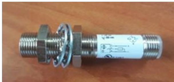
Figura 28 Sensor inductivo en unidad impresora
