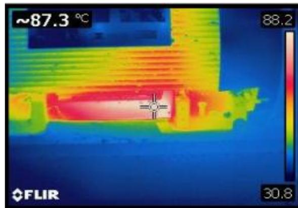
Figura 3. 9 Diagnóstico termográfico de motor de refinador #5
