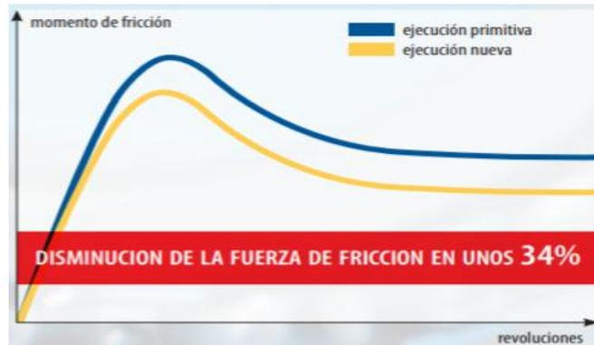
Figura 2. 56 Influencia del mejoramiento de diseño interno sobre el momento de fricción.
