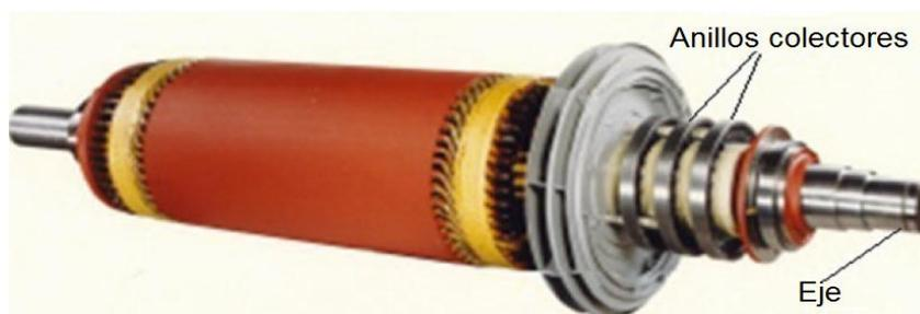
Figura 2. 7 Rotor de anillo deslizante
