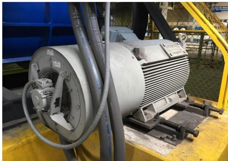
Figura 2. 14 Motor clasificación H con ventilación forzada
