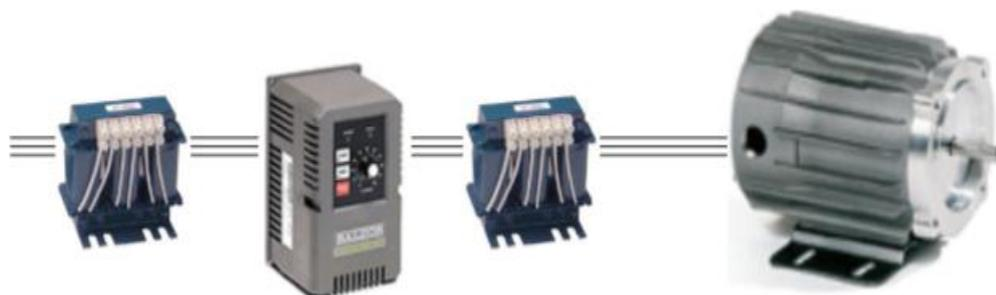
Figura 2. 60 Conexión de reactancias en un variador
