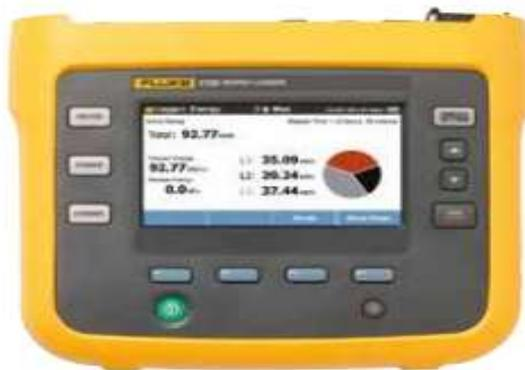
Figura 2. 43: Analizador de redes Fluke 1730
