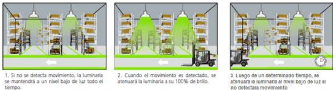
Figura 8. Función 2, tomado del catálogo de soluciones industriales Sylvania.
