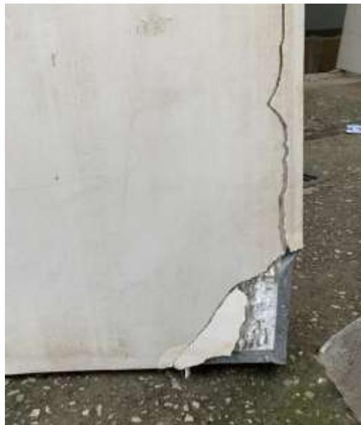
**Ilustración 30: Espécimen de panel con placa de óxido de magnesio, falla en las esquinas.**
