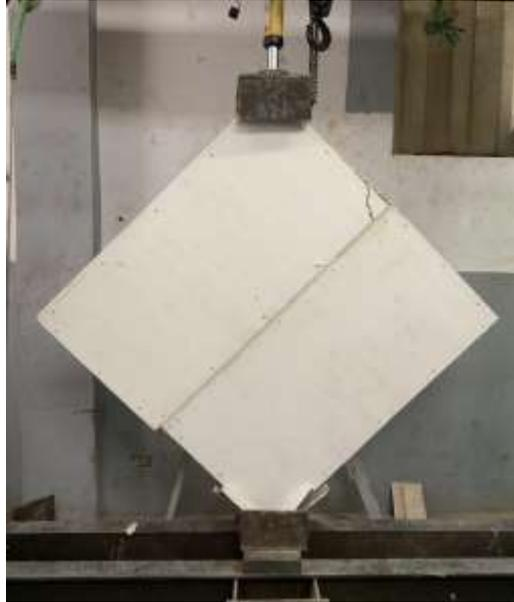
**Ilustración 29: Espécimen de panel con placa de óxido de magnesio al ser sometido a compresión diagonal, falla por aplastamiento.**
