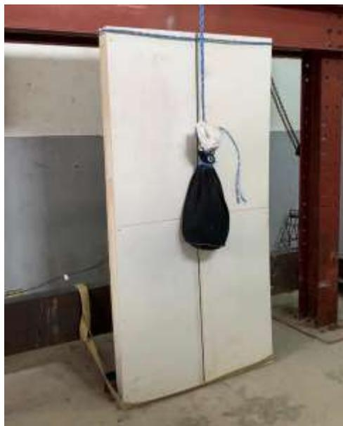
**Ilustración 36: Momento del impacto al espécimen de panel con placa de óxido de magnesio.**
