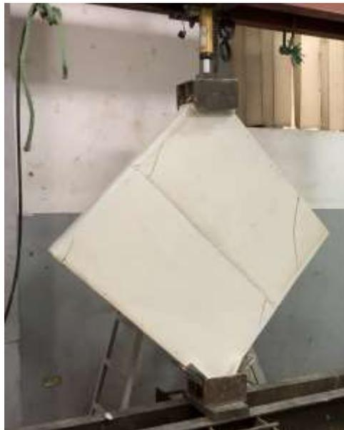
**Ilustración 28: Espécimen de panel con placas de óxido de magnesio, sometido a la carga máxima que resiste.**
