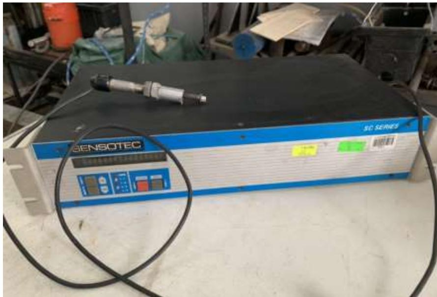
**Ilustración 31: Equipo del deformímetro utilizado para el ensayo de resistencia al impacto.**
