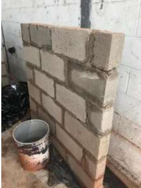
**Ilustración 11: Elaboración de los especímenes de mampostería tradicional, pegada de bloques.**
