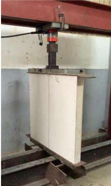
**Ilustración 18: Especimen montado para realizar ensayo a compresión simple.**
