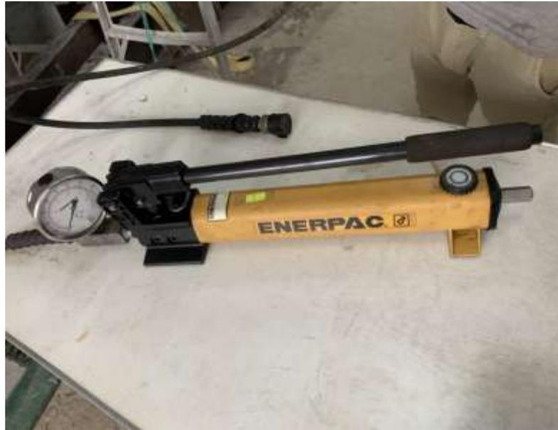
**Ilustración 24: Sistema hidráulico utilizado para los ensayos de compresión diagonal.**
