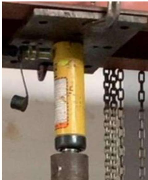
**Ilustración 25: Sistema hidráulico de 15ton.**
