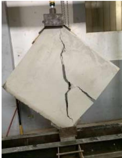
**Ilustración 26: Especimen con bloques de hormigón, sometido a carga máxima que resiste.**
