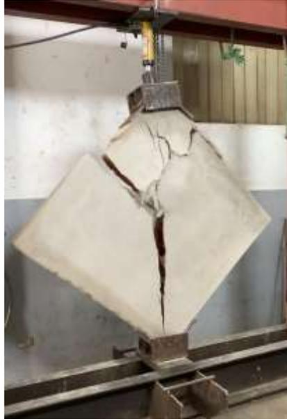
**Ilustración 27: Espécimen con bloques de arcilla, sometido a la carga máxima que resiste.**
