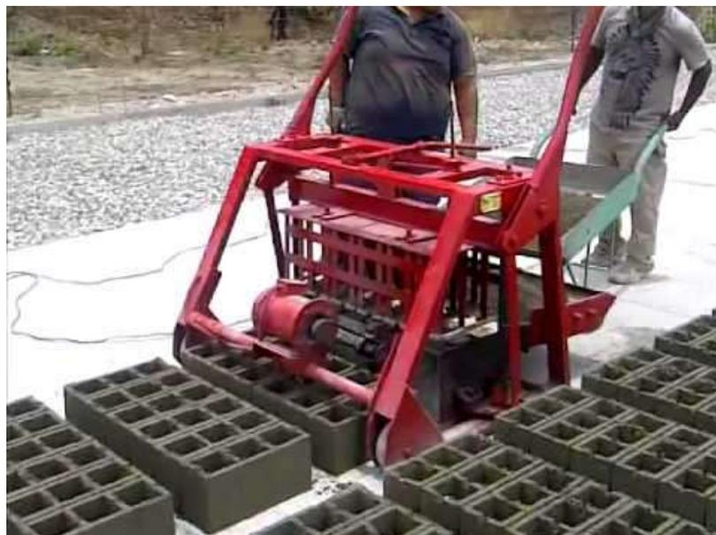
**Ilustración 4: Fabricación de los bloques de hormigón simple.**
