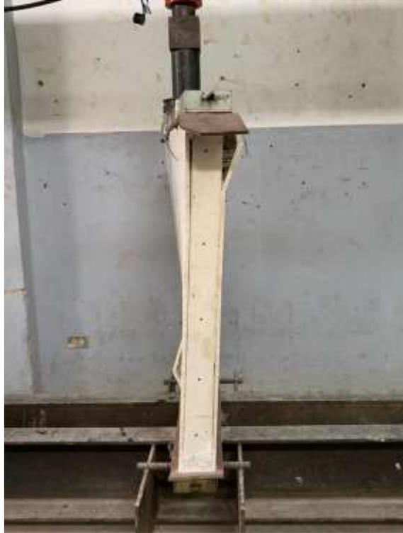
**Ilustración 19: Espécimen luego de haber aplicado la máxima carga.**
