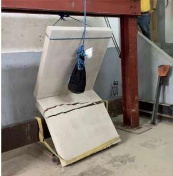
**Ilustración 35: Momento del impacto al espécimen con bloques de arcilla.**
