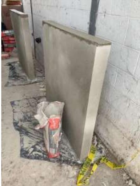
**Ilustración 13: Elaboración de los especímenes de mampostería tradicional, acabado.**
