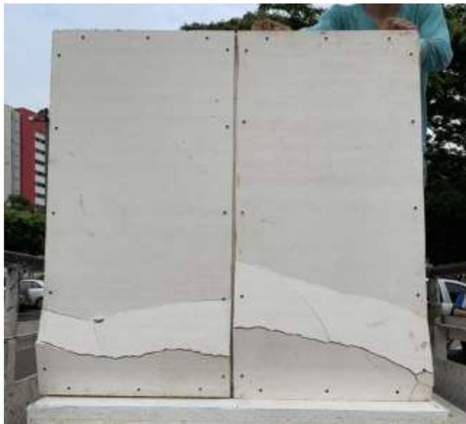
**Ilustración 20: Espécimen de panel con placa de óxido de magnesio luego de ser sometido a compresión, falla por aplastamiento.**
