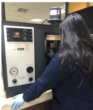
Figura 8. Ensayo de envejecimiento en horno de película delgada Fuente: Autores
